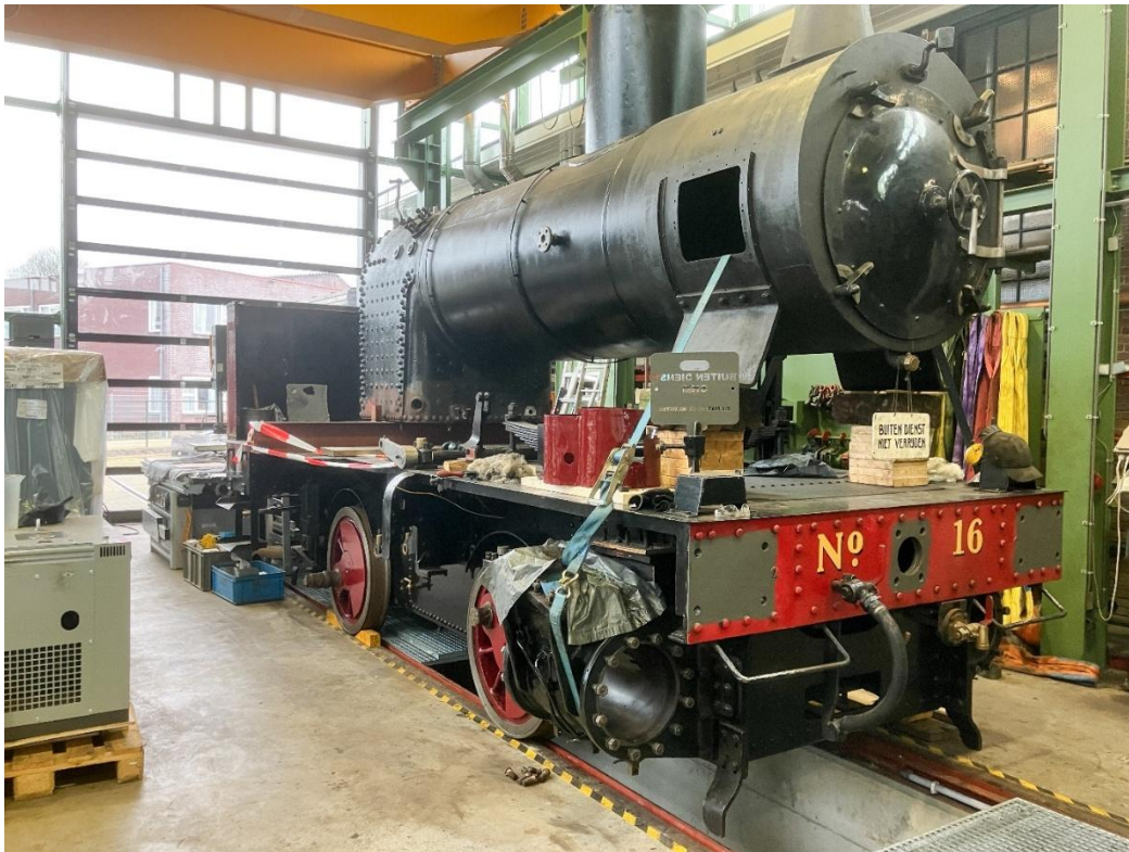
12 februari: van loc 16 is de ketel omhoog gebracht, om ook werkzaamheden aan de onderzijde van de voorkist te kunnen uitvoeren.
