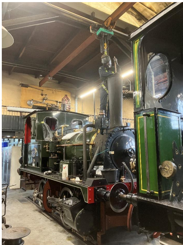
Achteraan op spoor 2 wordt gewerkt aan loc 6513. Duidelijk te zien is dat de dagen van het werken op gammele planken en wiebelende trapjes definitief voorbij zijn. Beschermings- en veiligheidsmiddelen zijn nu de norm.
