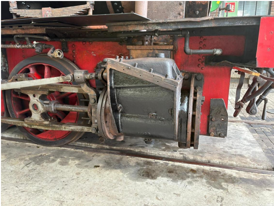
6 september 2025: van loc WSM 23 werd nu ook het cylinderblok voorzien van een beschermende coating.
