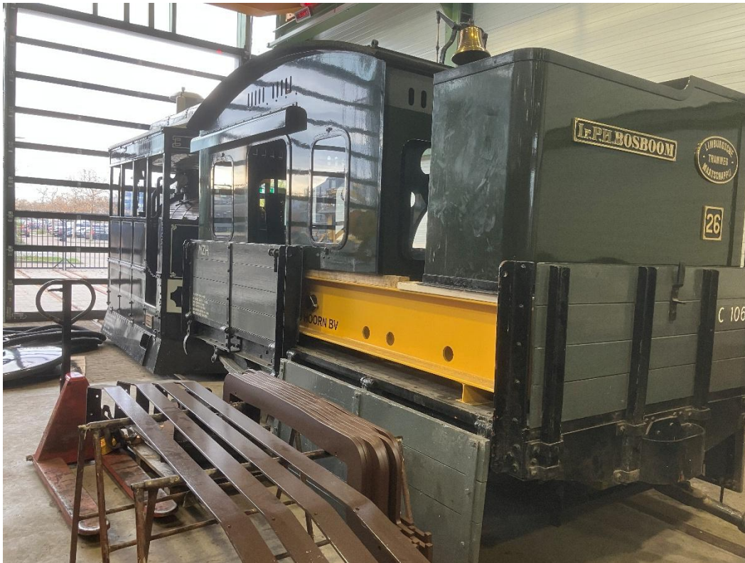
31 oktober 2025: de oververhitter-elementen worden uit loc 26 verwijderd, ter voorbereiding op een reparatie aan de stoomketel. Het machinistenhuis werd al eerder afgenomen en tijdelijk opgeslagen op het NZH goederenwagentje.
