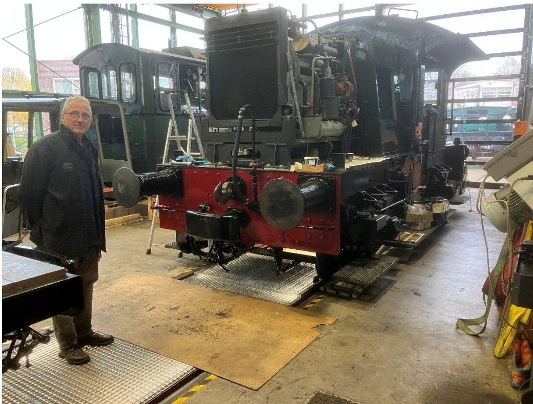
31 oktober 2025: aan locomotor 271 wordt gestaag doorgewerkt; vele lucht-, olie-, brandstof- en elektriciteitsleidingen vinden hun weg.
