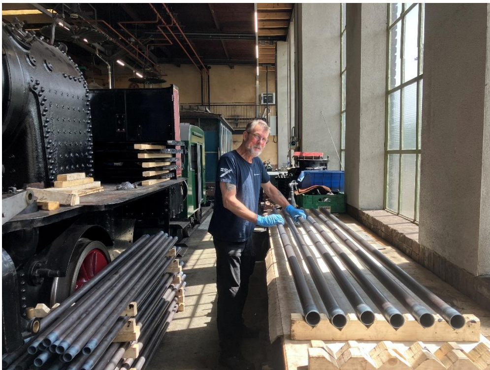
Van loc 16 worden onder (veel) andere de vlampijpen vernieuwd. Alvorens die kunnen worden gemonteerd in de ketel krijgen ze een uitgebreide behandeling: ze worden een voor een geschuurd, ...
