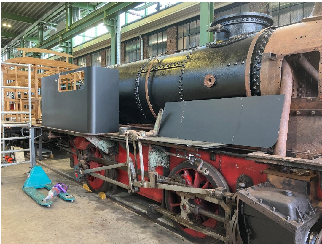
22 september 2025: nieuw plaatwerk voor loc WSM 23.
