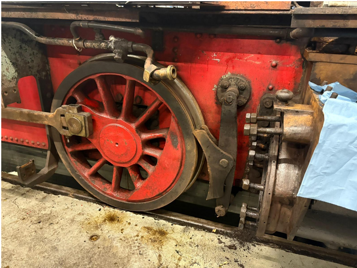
11 oktober 2025: van locomotief WSM 23 werden drijfwerk, zuigers en schuiven verwijderd in het kader van de gedeeltelijke revisie die deze loc momenteel ondergaat.
