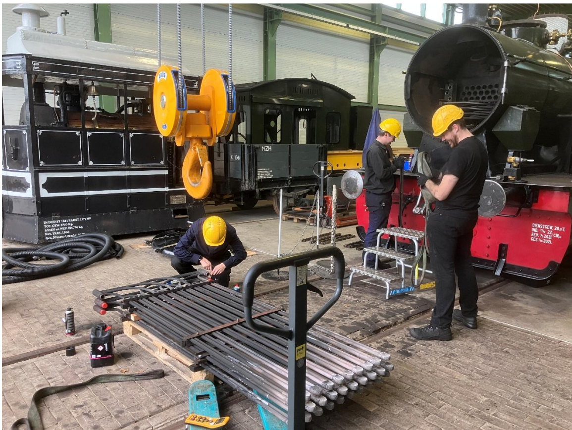
11 oktober 2025: van locomotief WSM 23 werden drijfwerk, zuigers en schuiven verwijderd in het kader van de gedeeltelijke revisie die deze loc momenteel ondergaat.
