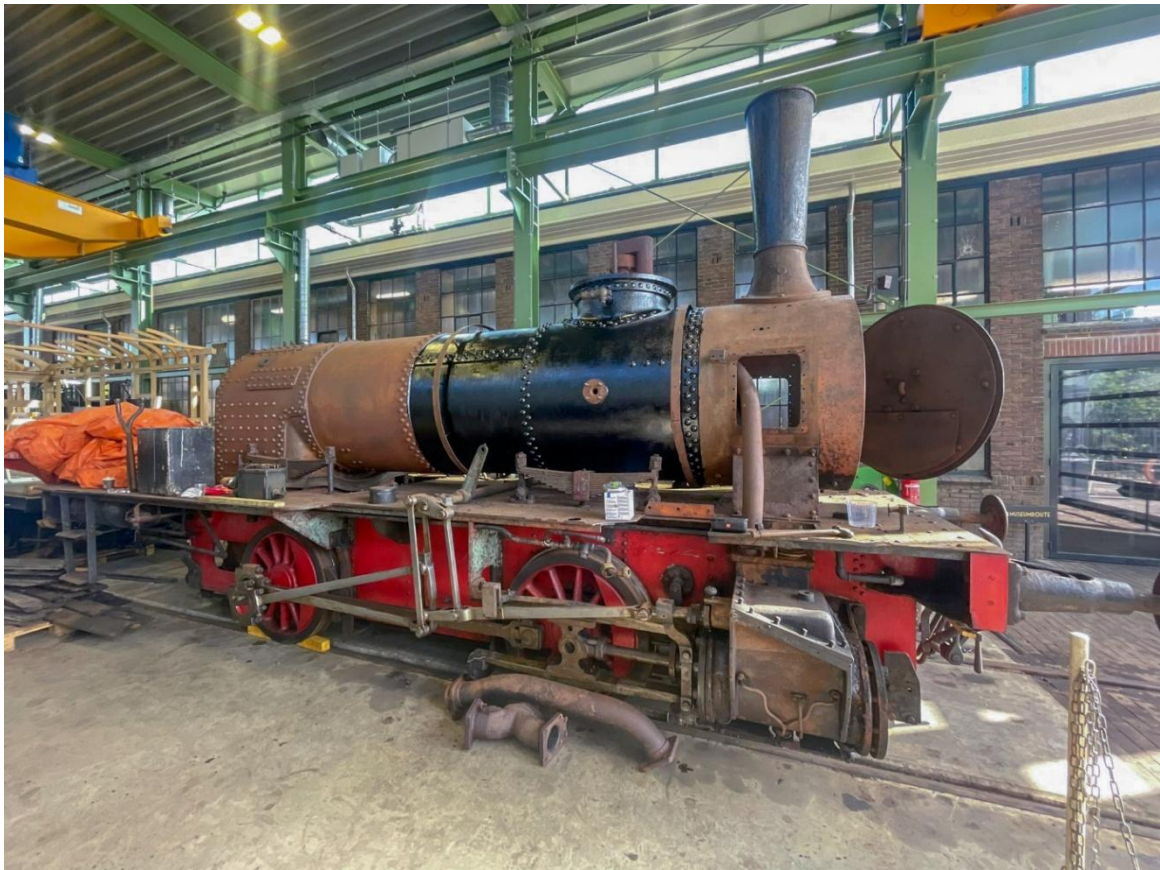
17 mei 2025: loc WSM 23 wordt voorbereid om nieuwe ketelbeplating te kunnen aanbrengen.
