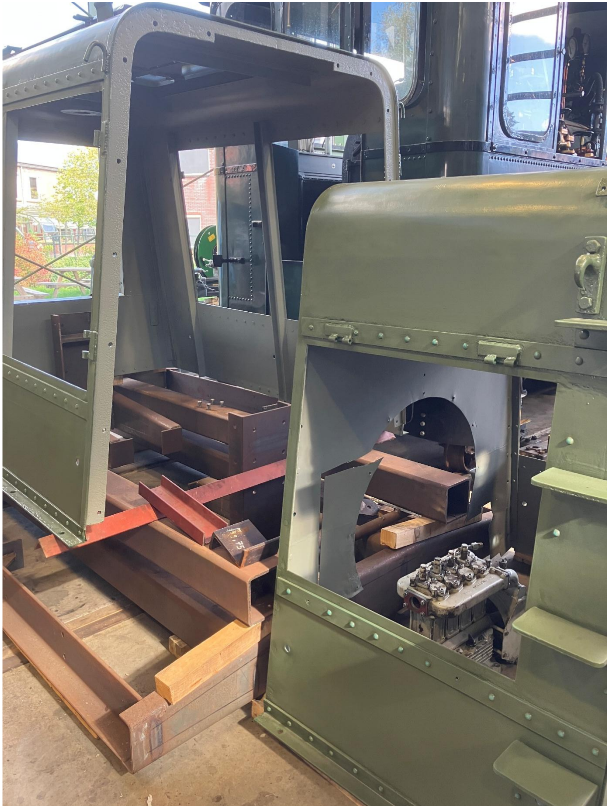
De generator- en motorhuif van locomotor NS 271, met daarin de nog in te bouwen luchtcompressor. De huiven zijn afgenomen om in- en uitwendig geschilderd te worden.
