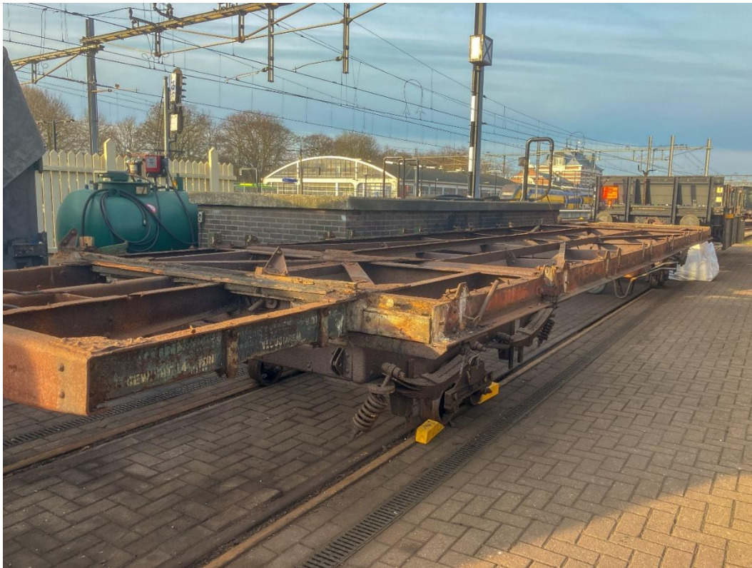
19 februari 2025: 'Bello-rijtuig' 425 in de staat waarin het leven van elk rijtuig begint, als onderstel.
