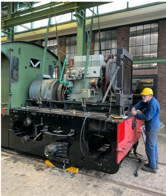
12 februari 2025: locomotor 271 heeft z'n motor en generator weer terug.
