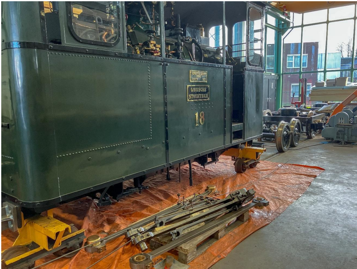
Loc 18 krijgt een tussentijdse revisie waarbij onder (veel) andere ook de schortplaten rond de wielen weer zullen terugkeren.
