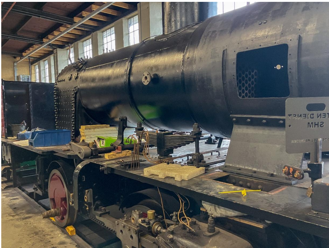
24 april 2025: de ketel van loc 16 is voorzien van een beschermende coating.
