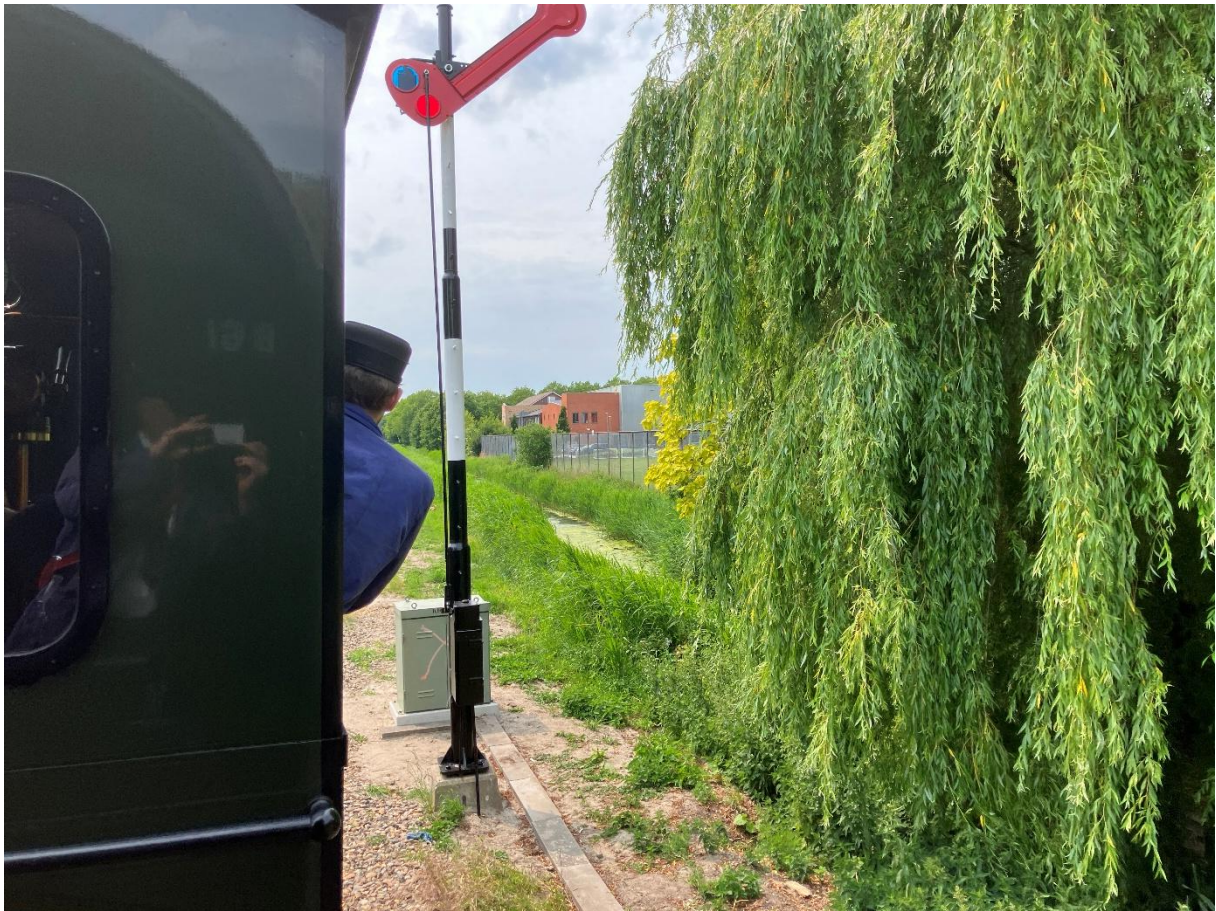
3 juni 2025: het inrijsein voor Hoorn Tramstation is verplaatst van nèt voor de overweg Koepoortsweg naar enkele honderden meters voor de overweg Liornestraat. Indien het sein - zoals op deze foto- in de stand “voorbijrijden toegestaan” staat, kunnen trams uit de richting Medemblik met 30 km/u doorrijden.
