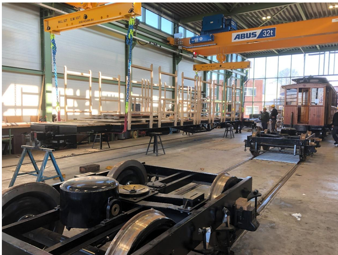
5 november 2024: het onderstel van Bello-rijtuig 455 wordt opgetild ...
