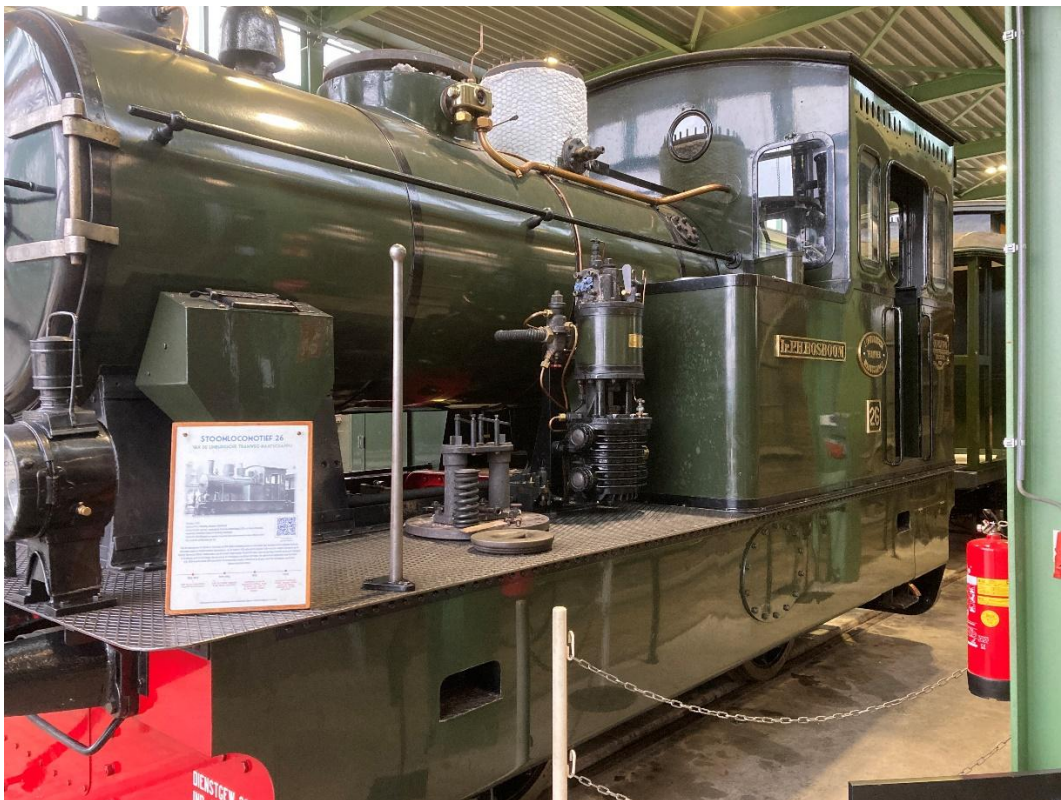
19 februari 2024: alle stoomlocomotieven (behalve loc 6513, die deze week de tramdienst op Wognum onderhoudt) staan voor onderhoud en/of ketelkeuring in de werkplaats, zoals hier loc 26 met afgenomen veiligheidskleppen, geopende stoomdom en uitgenomen appendages.
