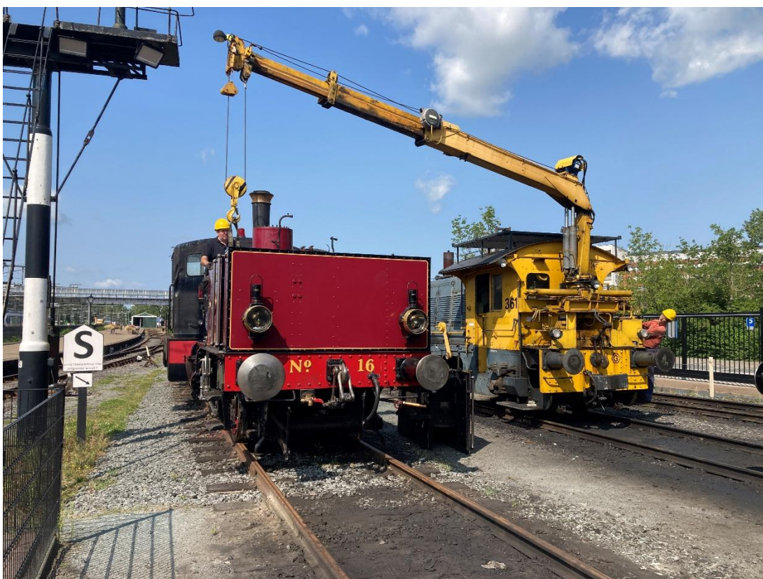
17 augustus 2024: in het kader van haar grote revisie wordt loc 16 ontdaan van machinistenhuis, kolenbakken, ketelbeplating en verdere zaken die in de weg zitten.
