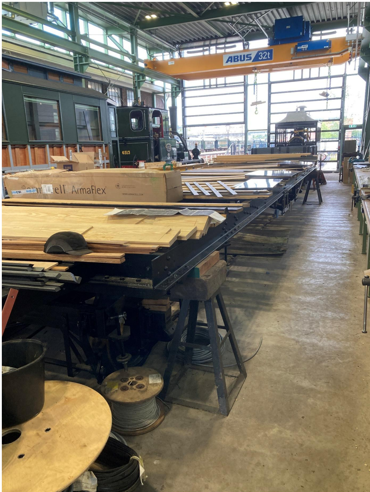
Het onderstel van rijtuig 455, voorzien van het meeste vloerhout alsmede talrijke onderhanden onderdelen.
