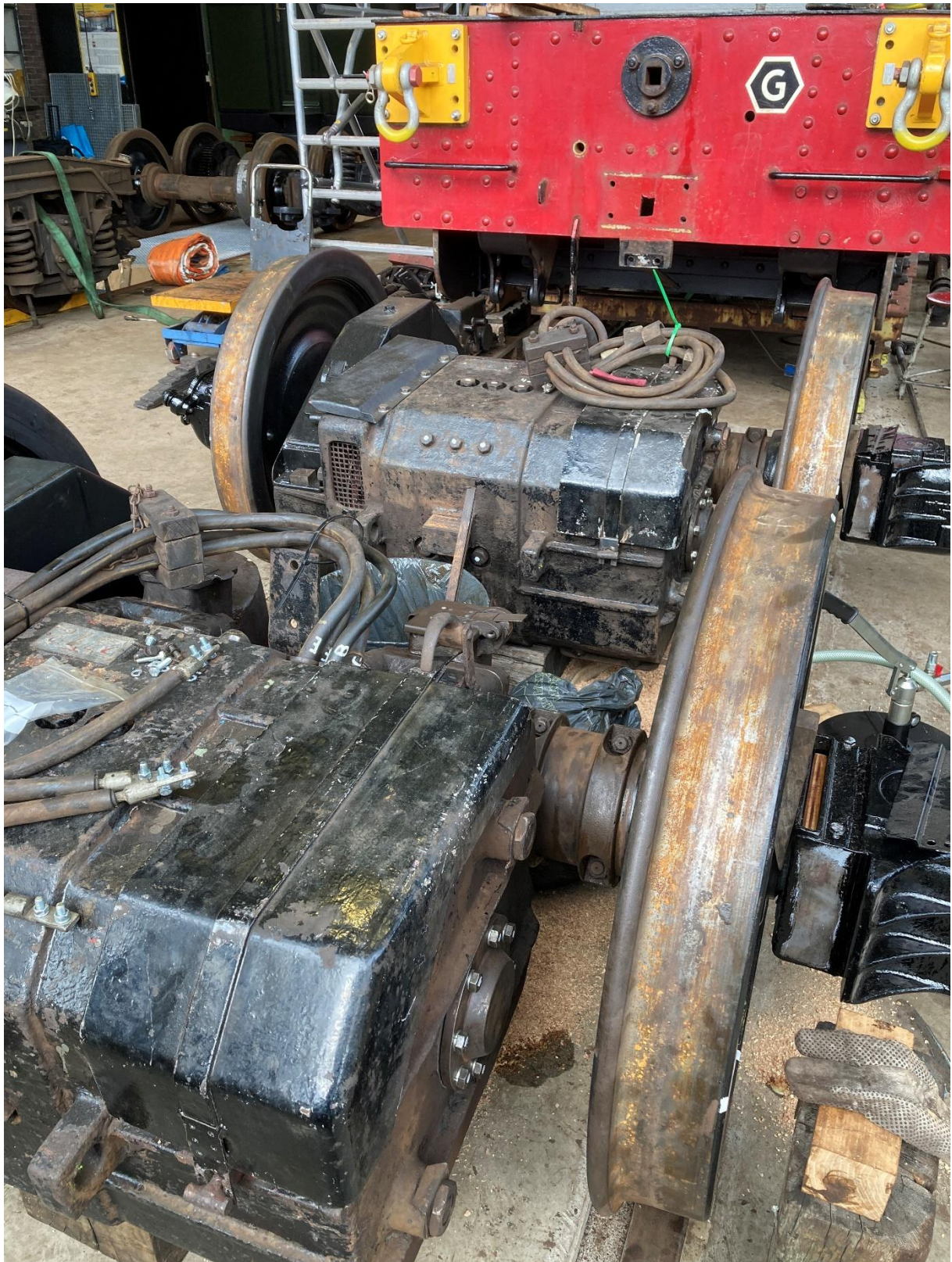
19 juni 2024: in de werkplaats zien we de gereviseerde tractiemotoren van locomotor 271 alweer op de wielstellen hangen.
