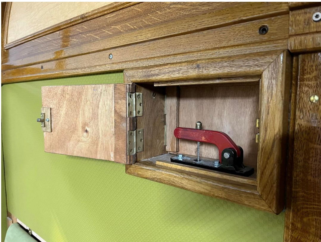
Tussen de beide afdelingen in bevindt zich de noodremtrekker, die na opening van een houten deurtje van beide kanten bediend kan worden.
