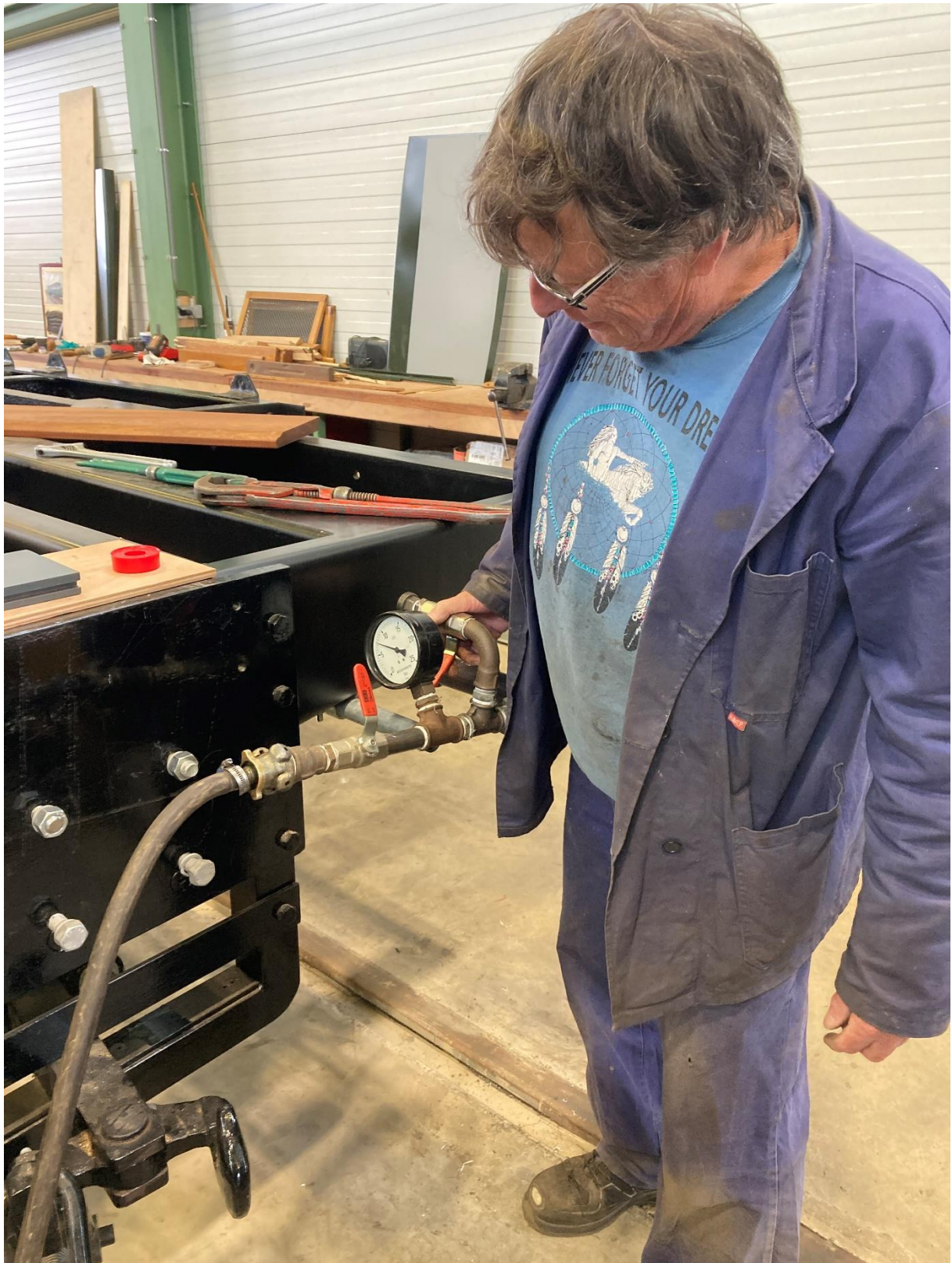
Van rijtuig 455 wordt de stoomverwarmingsleiding onder druk getest. Resultaat: in orde!
