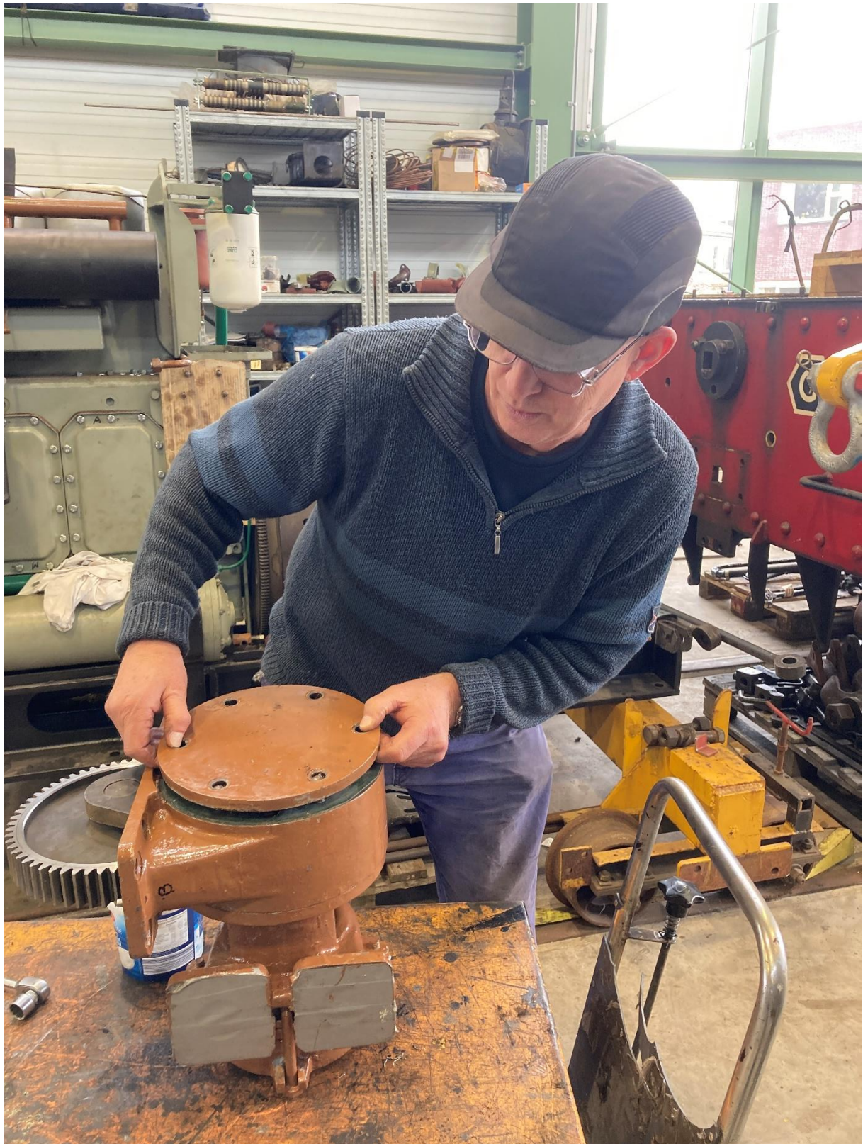
15 maart 2024: de koelvloeistofpomp van locomotor 271 wordt weer in elkaar gezet na volledige revisie.
