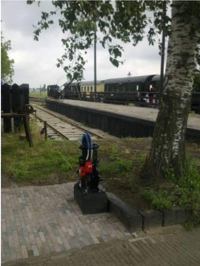
7 september 2012: grendel t.b.v. de wissels in spoor 3 te Wognum.
