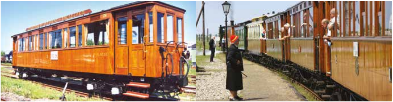
Personenwagen SBM 24 war von 1927 bis 1949 im Einsatz bei der Dampfkleinbahn Breskens (Provinz Zeeland)-Maldegem (Belgien) und wurde in seine Ursprungsform zurückversetzt, einschließlich Petroleumbeleuchtung.
